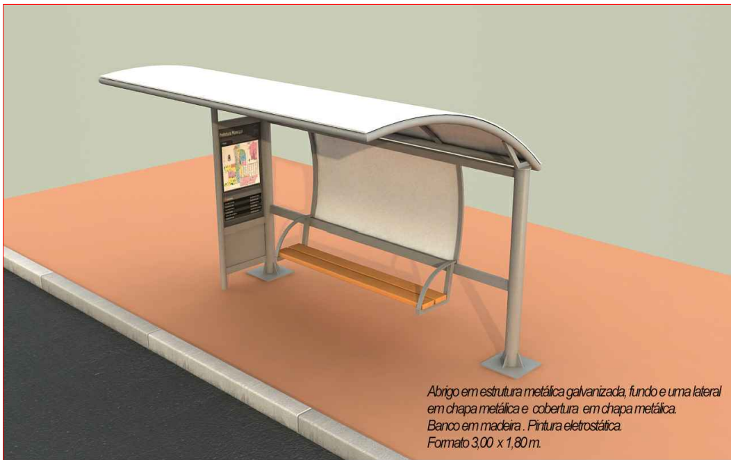
01 | Abrigo de passageiros - Perspectiva SEM ESCALA - Abrigo em estrutura metálica galvanizada, fundo e uma lateral em chapa metálica e cobertura em chapa metálica. Banco em madeira. Pintura eletrostática. Formato 3,00 x 1,80m.
